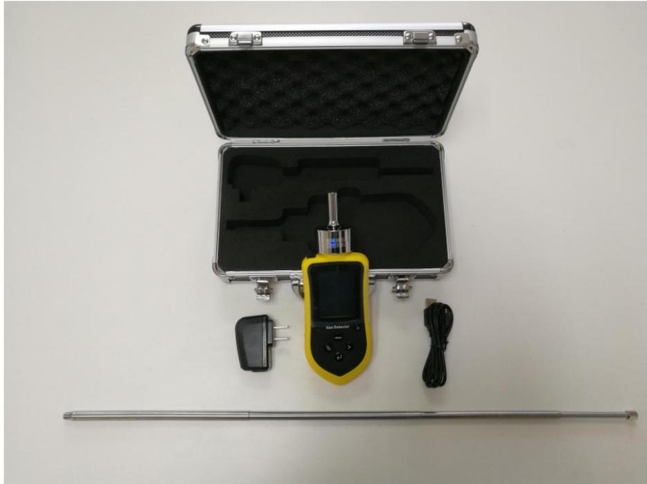
深国安便携式磷化氢检测仪还有扩散式、泵吸式、探杆式三种采样方式，用户可以根据实际来进行选择。深国安方面也可以根据具体的需求来进行相关的推荐。
