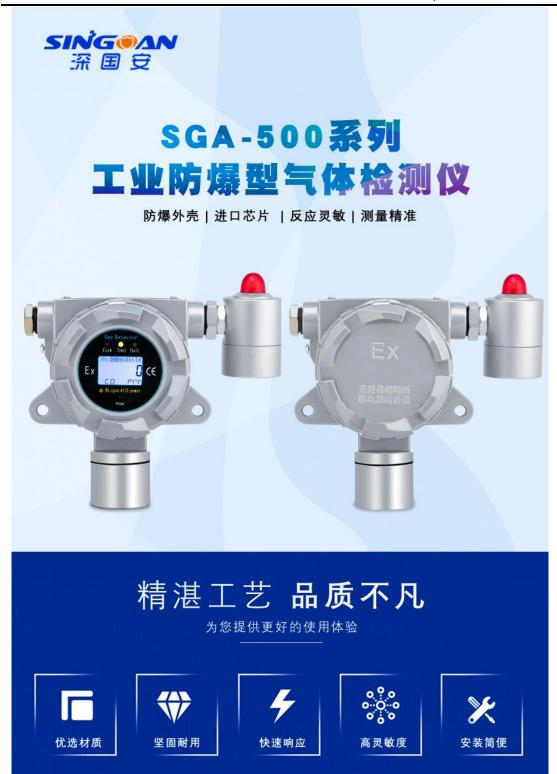
深国安氯气检测仪因其配备有防爆外壳, 且采用本质安全型电路设 计,所以可以在非常恶劣的环境下使用。而且用户也可根据企业本身 自有的相关系统进行输出信号的选择,也可以 RS485、4-20mA 双信
