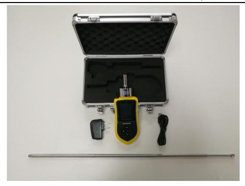
最后用户关心的问题就是氯气检测仪怎么安装。氯气气体分子量约为 70。也就是说氯气泄漏的话,气体是往下沉的。所以,氯气检测仪的 安装位置一般为泄漏源下方的 30-50cm 处。这样氯气泄漏的话,氯 气检测仪就可以快速的检测到泄漏的氯气。气体超标自动进行声光报 警,安全无忧。
