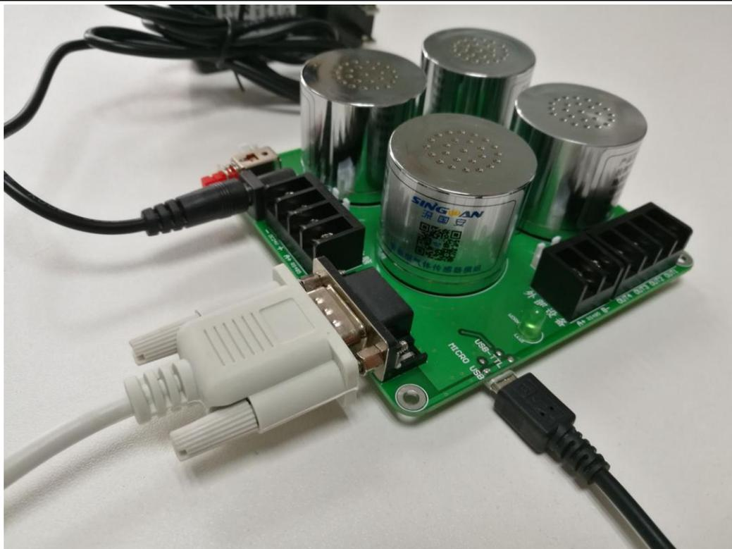
深国安智能型传感器模组根据其自身的特点。不仅在精度上有了质的飞跃。可以运用在大气监测、空气监测站、实验室等精度要求高的地方。大气监测的常规四气中，深国安智能型传感器模组也经常运用于大气常规四气的监测。其 PPB 级别的分辨率，是运用在大气监测中的基本要求。
