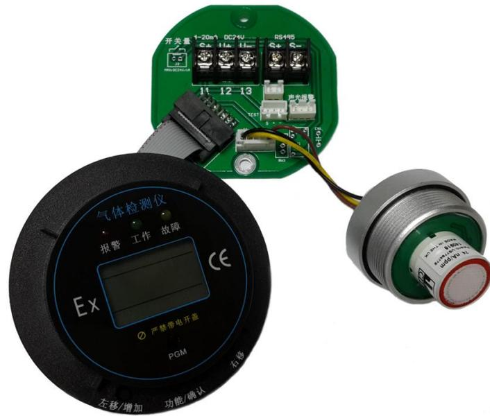
深国安气体检测模块主要功能为 24V 供电，可直接输出 4- 20mA 电流信号、RS485 通讯协议、或 0-5V 电压等信号。也可选择 4-20mA、RS485 双信号。想要检测什么气体就用什么气体的传感器开发成气体检测模块。
