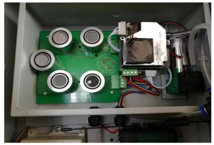
深国安微型空气监测站采样方式为泵吸式(主动采样式),可以将大气环境中的气体,吸进 微型空气监测站中,气体沿着软管的两个导向,一边进入到 PM2.5、PM10 传感器中,另一 边经过深国安智能传感器模组中, 其监测数据可以本地进行液晶显示, 因为深国安微型空气 监测站本身就配备有液晶显示屏, 当然也可以采集内部 232 信号, 进行大屏幕显示, 另外数 据通过内置的无线模块,统一传输到监测中心。
