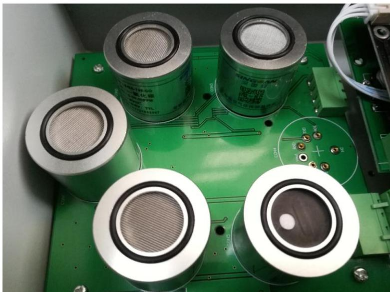
一氧化碳监测量程 0-20ppm、二氧化硫监测量程 0-1ppm、二氧化氮监测量程 0-1ppm、臭氧监测量程 0-1ppm，这些是属于在大气环境相对比较整洁的地方进行监测的常规量程。如化工厂的大气环境监测、厂界大气的监测、工地环境的监测，这些常规的监测量程就需要按照实际情况进行改变。一般这些地方的量程，会随着变大。如一氧化碳监测量程 0-100ppm、二氧化硫监测量程 0-5ppm、二氧化氮监测量程 0-5ppm、臭氧监测量程 0-5ppm 等监测量程。不同的监测环境选用不同的监测量程，最重要的是要满足监测条件，而这也是深国安产品属于专门定制的原因之一，需要根据现场实际情况和要求来定制产品。
