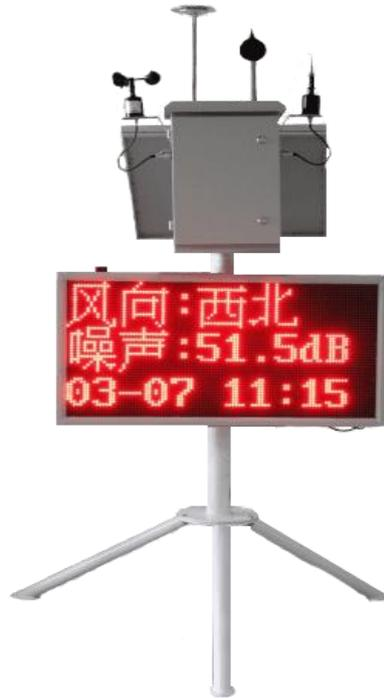
深国安多参数大气环境监测仪采用深国安独立研发的智能传感器模组。该智能传感器模组采用原装进口气体传感器，5V 供电、输出 0-5V 任意电压和 TTL 串口信号。可以将各种气体的智能传感器模组分别插入大气环境监测箱中，进行统一读取显示数据。
